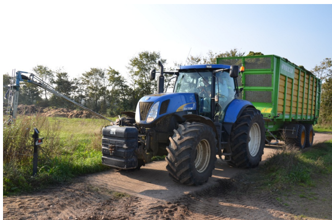
Eksakte udbyttmålinger på hver enkelt mark giver brugbar viden og plus på bundlinjen på Elmegården i Frederiks, når udbyttet vejes "i farten" på overkørselsvægten, der er centralt placeret i forhold til siloanlægget. Foto: Peter Hvid Laursen/VFL-Kvæg
